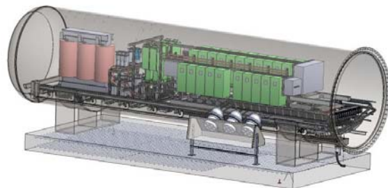
Figur 4. Ställverk som står på botten
